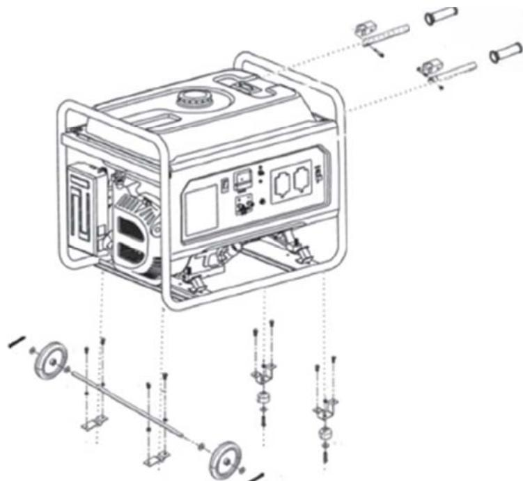
13.2 (1) Установите колеса на ось. Поставьте прокладки и шпильки.
