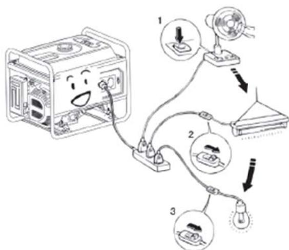
В целом, емкостная и индуктивная нагрузка, особенно устройства с электроприводом, обладают высокой пусковой мощностью. См. таблицу ниже.
