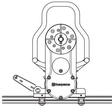
2. Чтобы закрепить резчик, передвигните ручку – фиксатор в крайнее положение от рельса.
