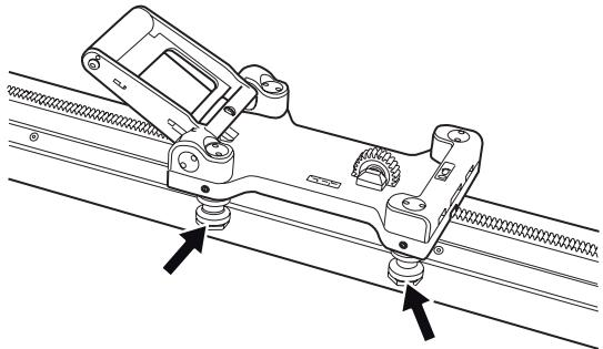
Сначала с помощью приложенного специального ключа ослабьте гайки (1). Затем ослабьте два стопорных болта (2). Когда они отпущены, настройте положение опорных роликов (3), поворачивая их к рельсу и, таким образом, устранивая зазор. Удерживая опорные ролики, затяните стопорный винт. Теперь затяните гайки, чтобы зафиксировать опорные ролики в новом положении.
