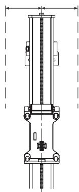
2. Просверлите отверстия диаметром 15 – 16 мм под анкеры для шпилек M12. Закрепите анкеры.
