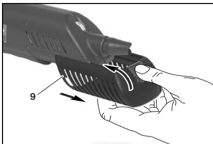
Нажмите на фиксатор на кассете для сбора пыли (9) и вытащите кассету назад.
