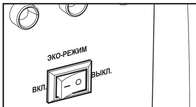
(1) «ВКЛ.» В данном положении блок управления регулирует частоту оборотов двигателя в соответствии с подключенной нагрузкой, что приводит к снижению расхода топлива и уровня шума.
