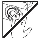
Опасность травмирования острыми лезвиями поворотных ножей. Учитывайте опасность, исходящую от вращающейся ножевой головки! Обратите внимание: после выключения двигателя и вместе с ним ножевая головка фрезера продолжают работать какое-то время по инерции!
