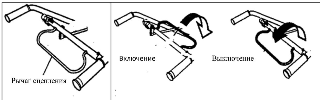
Данный рычаг соединен с натяжителем приводного ремня. В случае проскальзывания ремня следует отрегулировать длину штанги:
