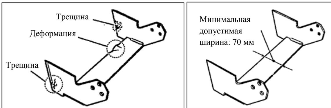
Состояние ножа влияет на производительность оборудования. При необходимости выполняйте заточку ножа.
