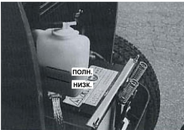
Рис. 59. Резервуар с охлаждающей жидкостью
