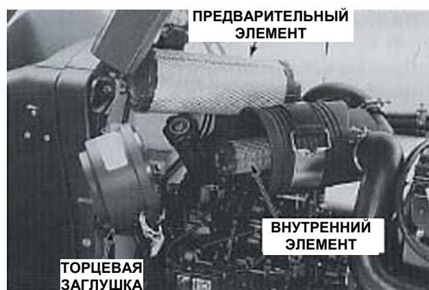
Рис. 54. Воздушный фильтр в разобранном виде
