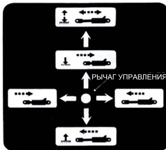
Рис. 42. Работа двухкаскадного клапана управления
