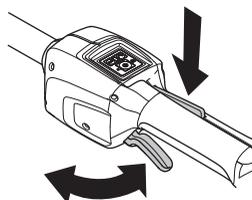
Режущий блок должен остановиться в течение 3 секунд.
