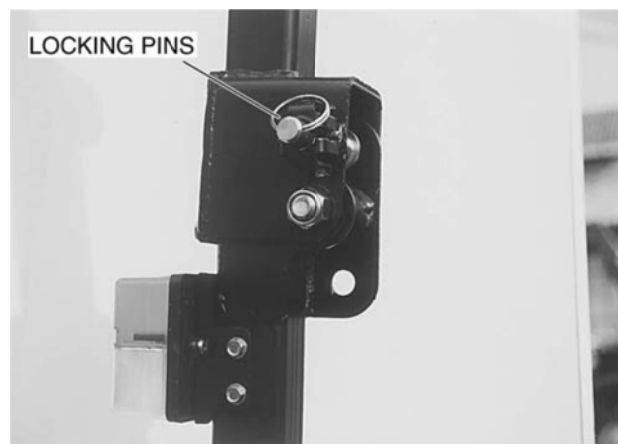
Рис. 5 (ROPS в поднятом положении)
