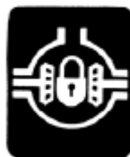
Механизм блокировки дифференциала Арт. № 390191690 Расположение над педалью под сиденьем
