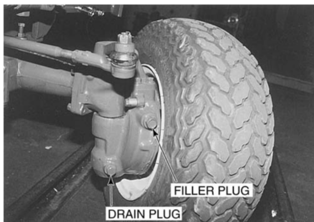
Рис. 83 (наливная горловина и сливная пробка картера понижающей передачи)
