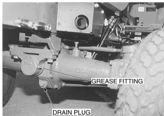
Рис. 82 (сливная пробка и масленка дифференциала переднего моста)
