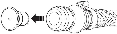
Чтобы увеличить поток воды при низком ее давлении, например, при использовании бака, можно демонтировать рестриктор.
