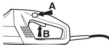
Пока выключатель питания нажат, фиксатор остается нажатым. Когда Вы отпускаете ручку, отпускается и выключатель и его фиксатор. Этим движением управляют две независимых возвратных пружины. В результате машина останавливается и выключатель фиксируется.
