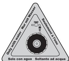
**ПРЕДУПРЕЖДЕНИЕ!** Непрерывно охлаждайте водой алмазные диски, предназначенные для влажной резки, чтобы предотвратить перегрев, способный повредить диск, и, далее, повредить машину и травмировать оператора.
