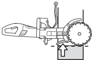
**ПРЕДУПРЕЖДЕНИЕ!** При любых обстоятельствах избегайте резки телом диска; он будет почти наверняка поврежден, разорван и может причинить огромные повреждения. Режьте только сегментами.
