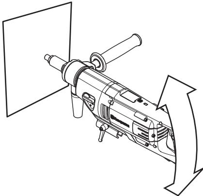
Kui seadme tagakülg on allapoole kaldu, siis keskmise rohelise LED kustub ning esimene punane LED süttib. Kui seadme tagumine külg on ülespoole kaldu, süttib tagumine punane LED.
