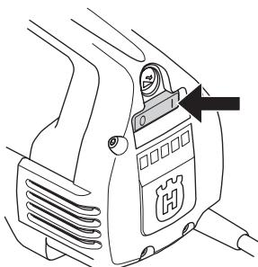
Выключатель используется для запуска и для остановки машины.
