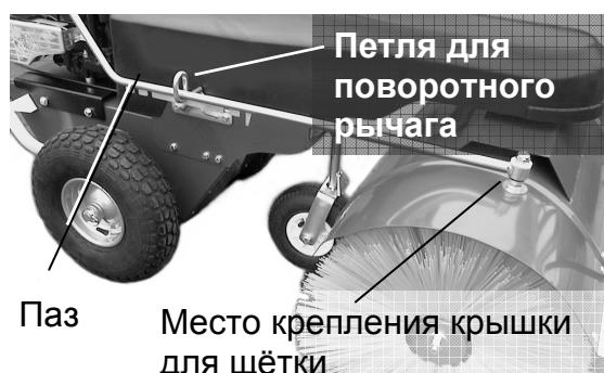
Протяните поворотный рычаг через петлю и подведите его к месту крепления. В месте крепления крышки для щётки протолкните конец поворотного рычага к резьбовой цапфе и зафиксируйте с помощью пластмассовой шайбы и стопорной гайки.
