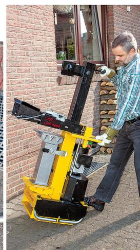
**Dank zwei Rädern** auf der Rückseite ist die 130-Kilogramm-Maschine leicht zu bewegen. Die silberne Stange unter dem oberen Griff ist ein Höhenanschlag, um das (zeitraubende) Zurückfahren der Spaltsäule bei kleinen Holzstücken zu begrenzen
