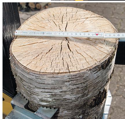
**Die maximale Stammbreite** liegt bei 32 Zentimetern. Mit diesem relativ feuchten Birkenstamm hatte das Gerät folglich keine Mühe. Für Holz über 55 cm Länge (bis 105 cm Länge) wird der graue Zusatztisch weggeschwenkt
