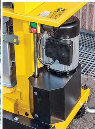
**Das Hydrauliköl** wird mittels Peilstab überprüft. Lläuft der 3000-Watt-Motor (oben), muss diese Öl-Schraube zwei Umdrehungen gelockert werden, damit im Tank des Hydrauliköls kein Unterdruck entsteht
