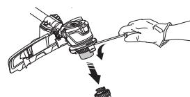
Снимите гайку, фиксирующую головку триммера и ведущий диск.
