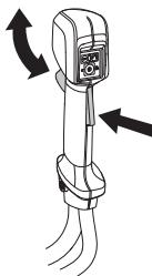
См. указания в разделе Запуск. Запустите машину на полную мощность. Отпустите переключатель и удостоверьтесь, что режущее оборудование останавливается и остается неподвижным.
