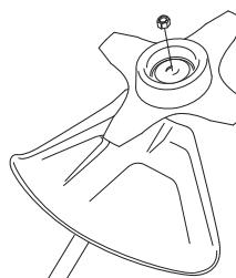
При сборке надо затягивать гайку против направления вращения режущего оборудования. При разборке надо отвинчивать гайку в направлении вращения режущего оборудования. (ЗАМЕЧАНИЕ! Гайка имеет левостороннюю резьбу.) Зафиксируйте вал режущего диска с помощью Г-образной шпонки.
