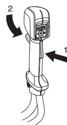
Проверьте, чтобы переключатель был зафиксирован, когда его стопор находится в исходном положении.
