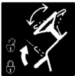
*Рычаг наклона рулевой
