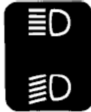
Выключатель дальнего света фар Арт. № 390230810 РАСПОЛОЖЕНИЕ: левая сторона приборной панели
