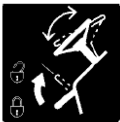
Рычаг наклона рулевой колонки Арт. № 390198970 РАСПОЛОЖЕНИЕ: левая сторона кожуха рулевой колонки
