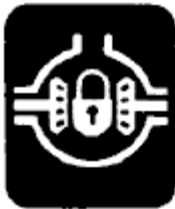
Механизм блокировки дифференциала Арт. № 390198301 РАСПОЛОЖЕНИЕ: верхняя педаль с правой стороны платформы
