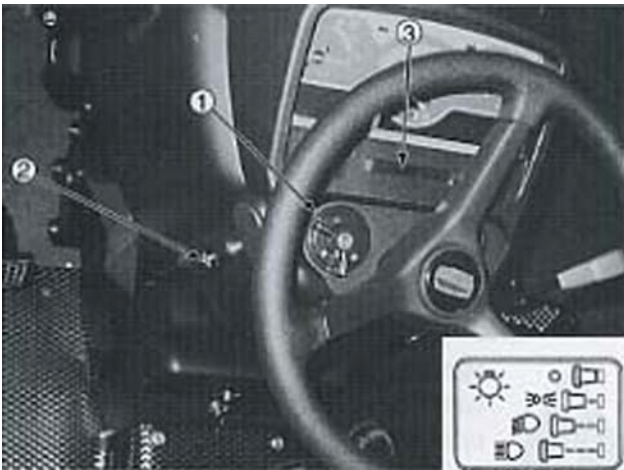
Рис. 7. (1) комбинированный переключатель, (2) основной выключатель световых сигналов, (3) световой индикатор поворота прицепа.
