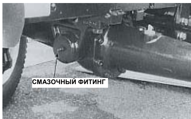
Рис. 82. Сливная пробка и смазочный фитинг дифференциала передней оси
