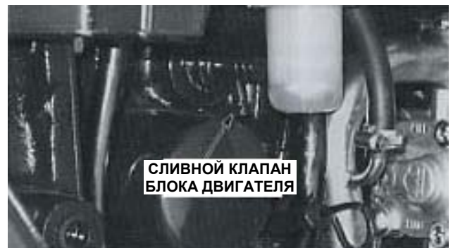
Рис. 60. Сливные клапаны на радиаторе и блоке двигателя
