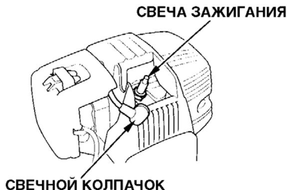
2. Осмотрите свечу зажигания. Замените ее, если заметны признаки износа или повреждения изолятора свечи. Почистите свечу проволочной щеткой, если Вы не обнаружили никаких видимых повреждений.
