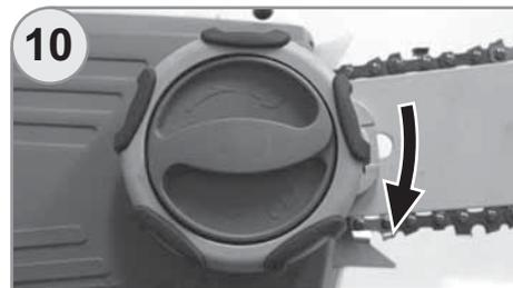
7. Поставьте боковую крышку, убедившись, что болт крепления шины совпал с резьбовым отверстием фиксатора. Заверните фиксатор (рис. 10).
