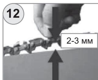
2. При правильном натяжении центральная секция цепи приподнимается приблизительно на 2-3 мм (рис. 12).
