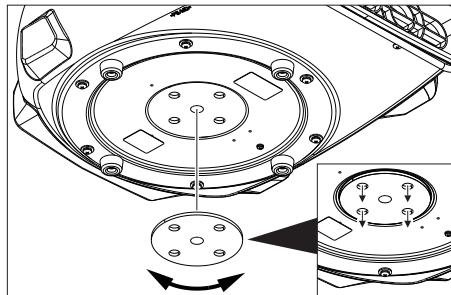
→ Повернуть регулировочный диск таким образом, чтобы открыть все 4 отверстия для выпуска воздуха.
