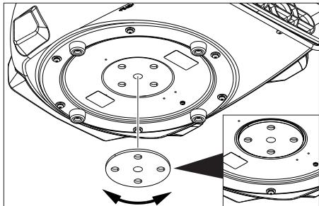
→ Повернуть регулировочный диск таким образом, чтобы закрыть все 4 отверстия для выпуска воздуха.
