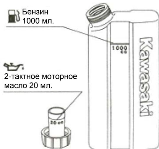
Емкость для подготовки топливной смеси (пример)
