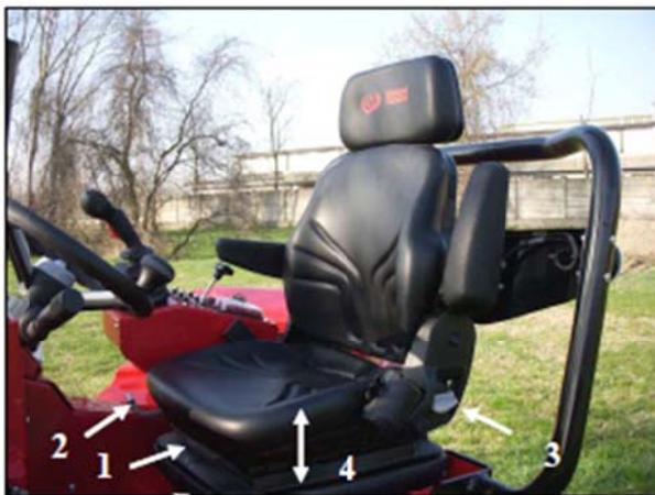
1. Рычаг регулирует жесткость сиденья в соответствии с весом оператора.
