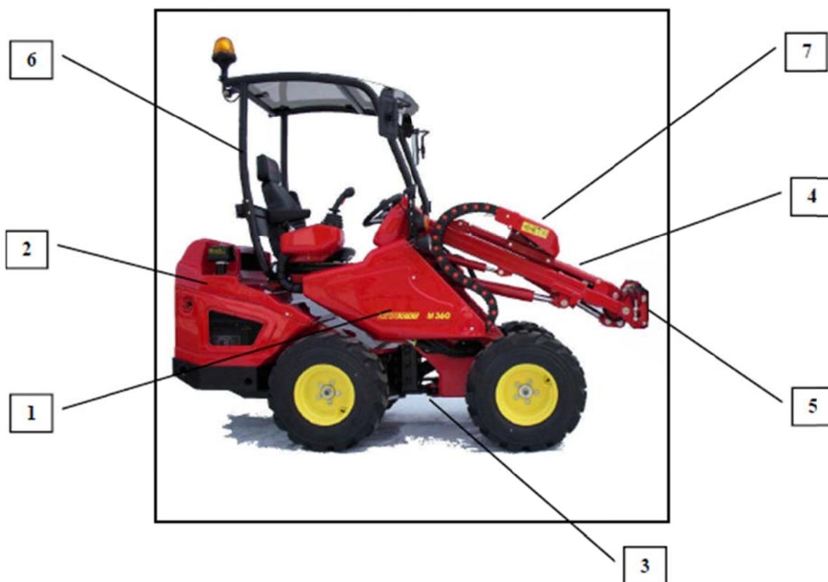
1. **ПЕРЕДНЯЯ РАМА.** Расположена перед шарнирным сочленением. На передней раме размещаются элементы управления, сиденье, выдвижной рычаг, топливный бак, передние колеса и точки соединения.
