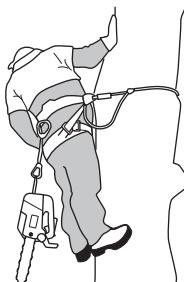
При перемещении пилы из одной точки крепления в другую оператор должен проверить надежность крепления в новой точке перед отсоединением от предыдущей точки.
