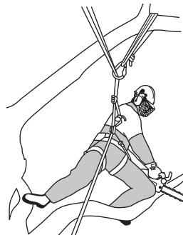
Дополнительную устойчивость ножной опоры обеспечивает временное ножное стремя из петлевого стропа.
