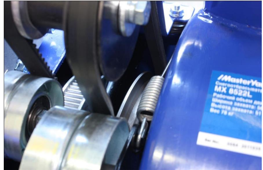
**Механизм привода колес и шнека.**
